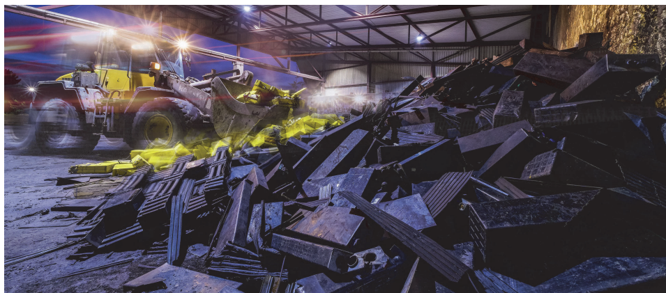
Sammlung und Rückführung von ausgedienten Blei-Säure-Batterien
