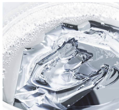
Mithilfe elektrolytischer Raffination wird hochreines Gallium produziert
