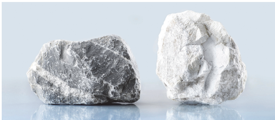
Links ungebrannter Kalkstein, rechts gebrannter Kalk
